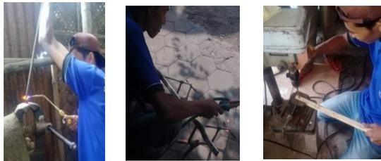
Gambar 5.8 Proses pembuatan *pipe bender portable*
