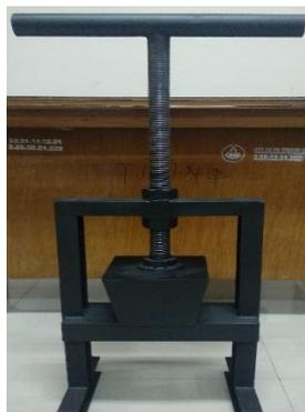
Gambar 4. Mesin Cetak *Biodegradable pot*
